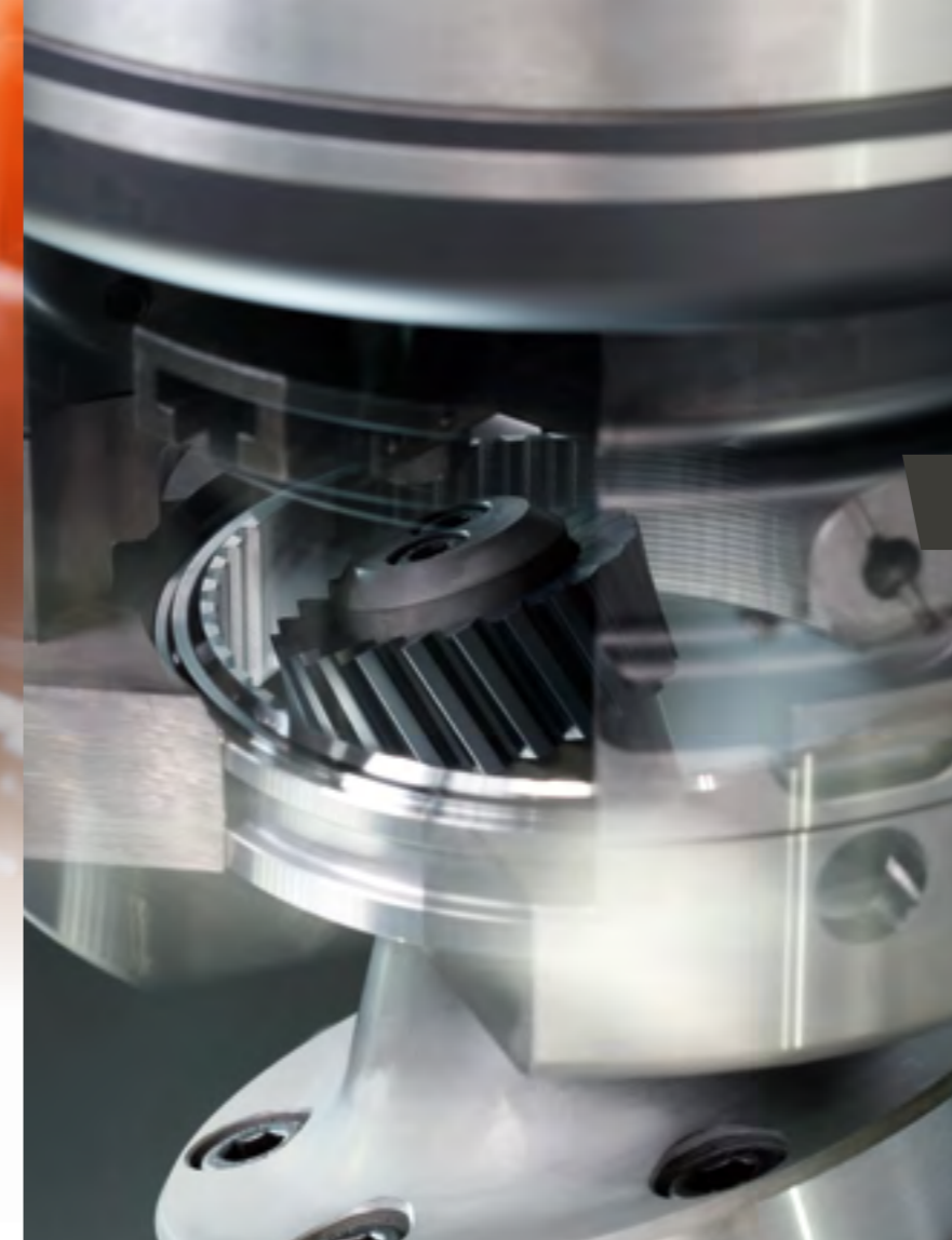
Wälzschälen eines Synchronrings Skiving of a synchronizer ring
