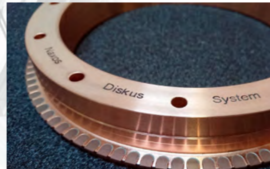
Formabrichtrollen für den CNC-bahngesteuerten Abrichtprozess – mit Polykristallinen (PKD) oder Monokristallinen (MKD) Plättchen belegt, die in einem speziell entwickelten Verfahren auf den Trägerkörper aufgebracht werden. / Form dressing rollers for the CNC path controlled dressing process - coated with polycrystalline (PCD) or mono-crystalline (MKD) plates, which are applied to the carrier body in a specially developed process.
