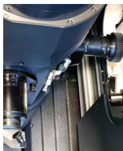
Das integrierte Werkzeugmagazin für bis zu 20 Werkzeuge The on-board tool changer for up to 20 different tools
