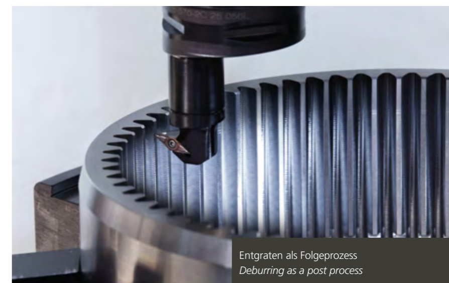
Verzählen mit PITTLER SKIVING Technologie Gearing with the PITTLER SKIVING technology
