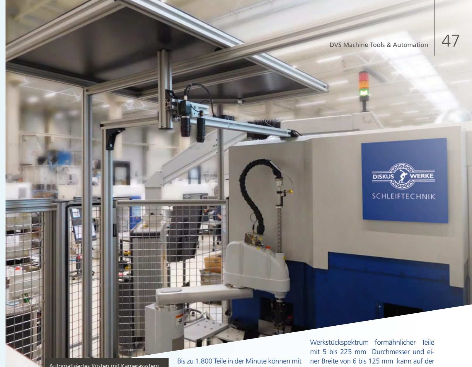
Automatisiertes Rüsten mit Kamerasystem Automated set-up with camera system
