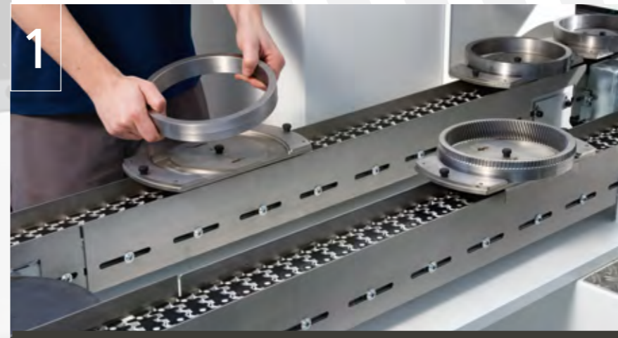
1 Eine Handbeladung kann direkt in den Arbeitsraum der PITTler Skive-Line erfolgen oder taktzeit neutral über ein Shuttlesystem. Manual loading can be carried out directly in the working area of the PITTler SkiveLine or via a shuttle system without any time delay.
