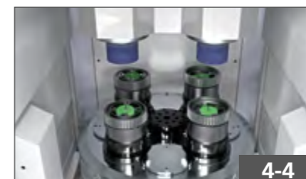
Anzahl Werkzeugspindeln: 4 Number of tool spindles: 4 Anzahl Werkstückträger: 4 Number of workpiece carriers: 4
