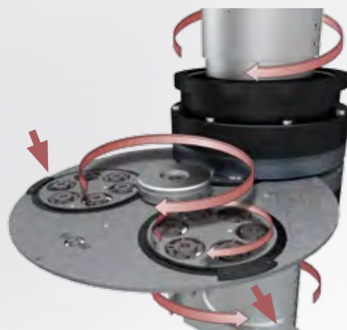
Abbildung 1: Einstechschleifverfahren Image 1: Plunge grinding
