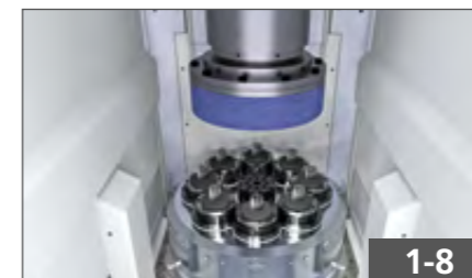
Anzahl Werkzeugspindeln: 1 Number of tool spindles: 1 Anzahl Werkstückträger: 8 Number of workpiece carriers: 8
