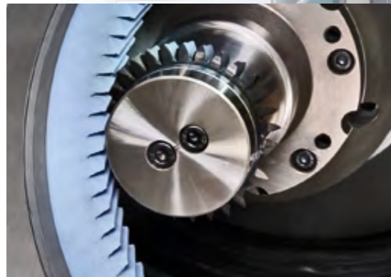
Abrichtvorgang mit VarioSpeedDresser® Dressing process with VarioSpeedDresser®
