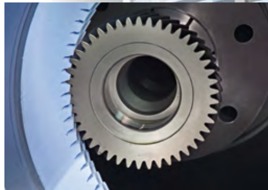
Verzahnungshonen einer Welle Gear honing of a shaft
