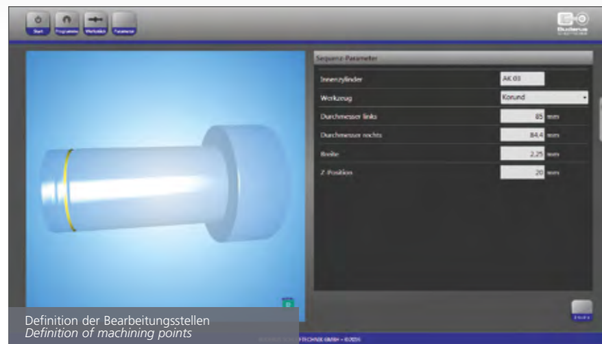
Eingabe der Werkstück-Geometriedaten Entry of the workpiece geometry data
